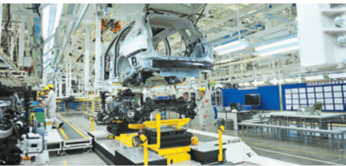
東風日產大連工廠總裝車間內，合裝 AGV 自動匹配到相應車體
